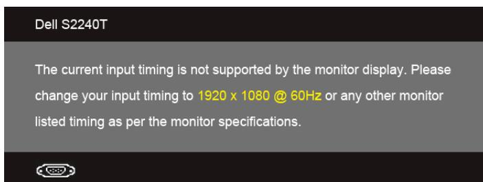
Сообщение означает, что невозможна синхронизация видеосигнала, принятого с компьютера. Допустимые диапазоны частот строчной и кадровой разверток, поддерживаемых этим монитором, см. в разделе [Технические характеристики монитора](#). Рекомендуется использовать разрешение 1920 x 1080.
