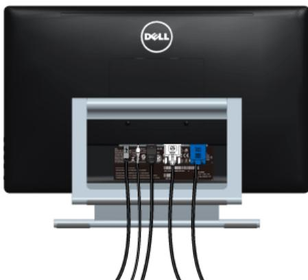
После подключения всех необходимых кабелей к монитору и ПК (см. [Подключение монитора](#) для подключения кабелей) воспользуйтесь отверстием для прокладки кабелей, как показано выше.
