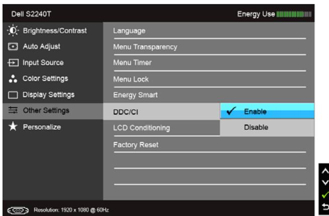
**Кондиционирование ЖКД** Данная функция позволяет устранить незначительные остаточные изображения на экране. Длительность выполнения программы зависит от интенсивности остаточного изображения. Можно включить данную функцию, выбрав параметр **Enable** (Вкл.).
