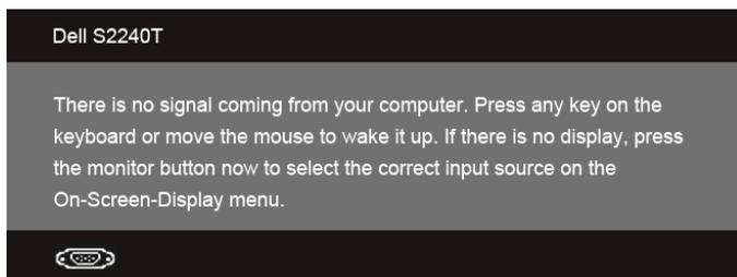
Если выбрать входной сигнал VGA, DVI-D или HDMI, когда соответствующий кабель не подключен, то откроется следующее плавающее диалоговое окно.
